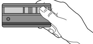
Répétez les étapes 3 - 4 ci-dessus avec le bouton jaune sur la télécommande et avec le bouton « B » Intelligent/apprentissage du récepteur pour programmer le mode FERMETURE, et à nouveau avec le bouton vert de la télécommande et avec le bouton « C » Intelligent/apprentissage du récepteur pour programmer le mode OUVERTURE.
