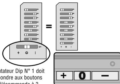
Commutateur Dip N° 1 doit correspondre aux boutons sur la télécommande à 3 boutons
