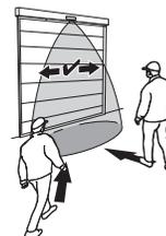
Inclinaison optimale pour la fonction de circulation transversale: de 30° à 45°
