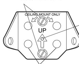
Le trou du clou n'est prévu que pour le positionnement seulement. Des tire-fond doivent être utilisés pour fixer le support de linteau.
