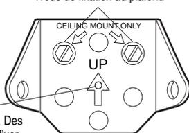
Le trou du clou n'est prévu que pour le positionnement seulement. Des tire-fond doivent être utilisés pour fixer le support de linteau.
