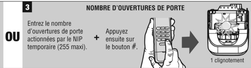
Pour tester l'ouvre-porte, appuyez sur le NIP temporaire, puis sur le bouton ENTER. L'ouvre-porte de garage s'actionne. Le test compte pour une ouverture de porte lorsque le NIP temporaire a été programmé pour un certain nombre d'ouvertures.
